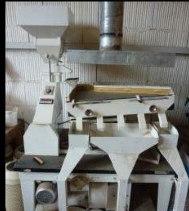
Verschiedene Reinigungsmaschinen ( Siebmaschine, Reiber, Tischausleser)
