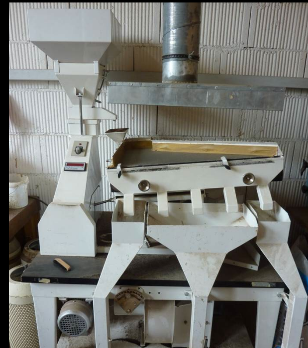
Verschiedene Reinigungsmaschinen ( Siebmaschine, Reiber, Tischausleser)
